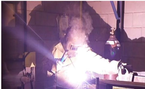
*Figura 1: Um funcionário da Person Helice's solda uma borda de hélice danificada.*
