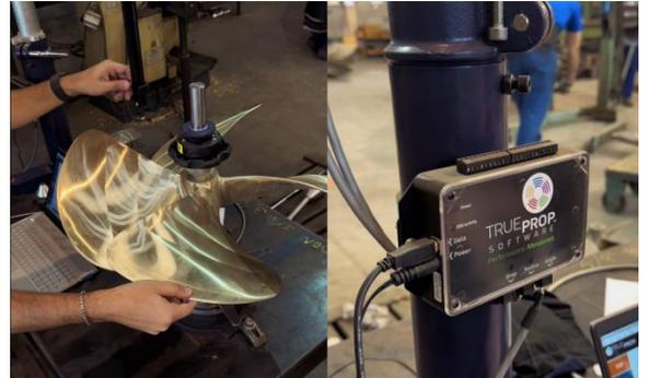
*Figura 3: O HELIX 48 é um sistema digital de medição de inclinação para hélices de até 48 polegadas de diâmetro.*
